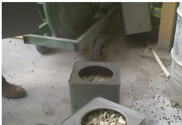
Figura 1: Aspecto do Asfalto Granular para dosagem na Usina de asfalto
