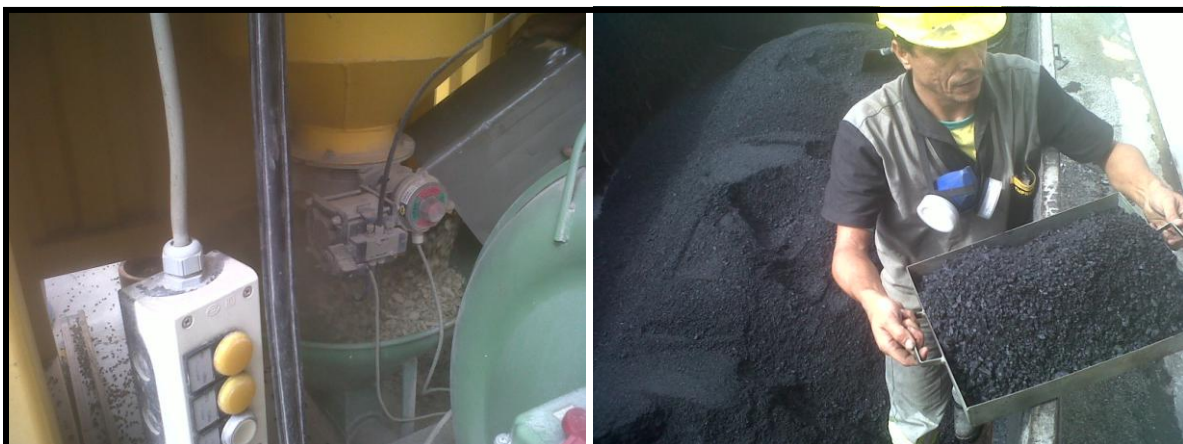
Figura 3: Detalhe da dosagem do asfalto granular e coletas de amostras para controle tecnológico
